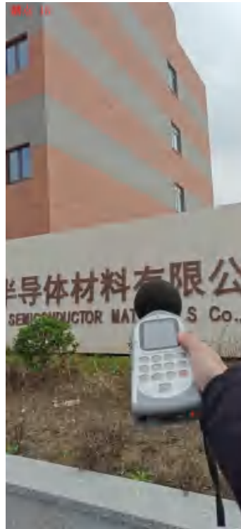
昼间厂界北侧噪声监测照片
