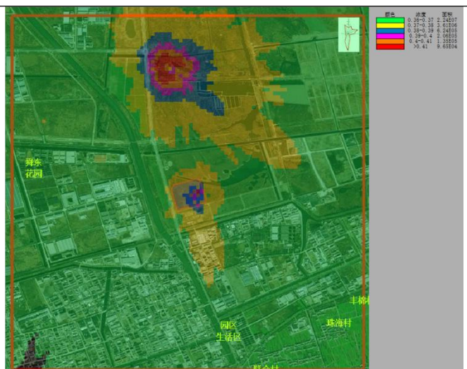
甲醇叠加后小时贡献浓度最大值分布图 ( \text{mg}/\text{m}^3 )
