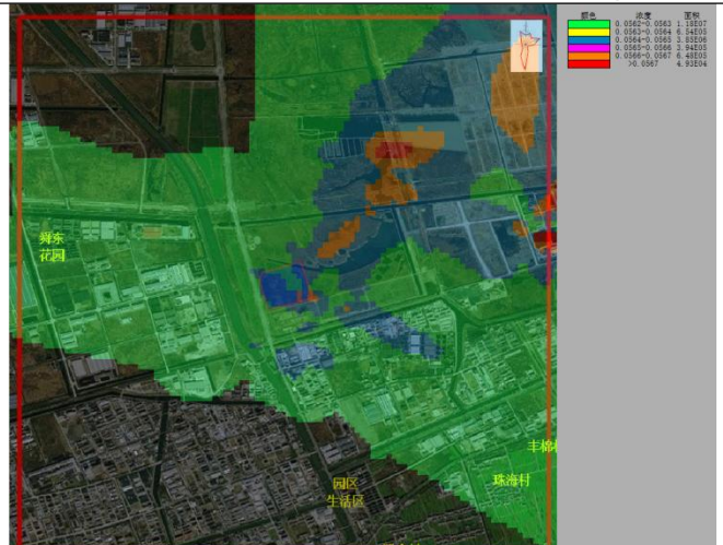
\text{PM}_{2.5} 叠加后日均贡献浓度最大值分布图 ( \text{mg}/\text{m}^3 )
